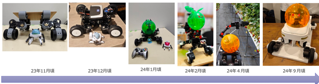
図 1：小型ロボット開発の進捗と形状の変化（筆者作成）
